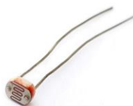
Lyssensor - måler lysstyrke
