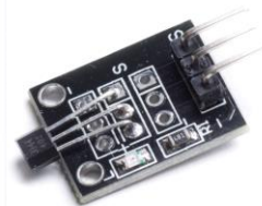
Halleffekt-sensor - måler magnetfelt
